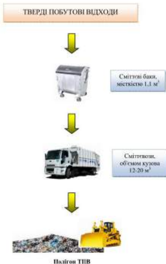
Рис 3.2 Типова система збирання твердих побутових відходів з вивезенням на полігон ТПВ
